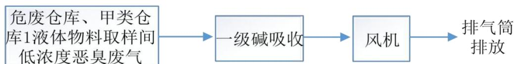
图 4-12 危废仓库、甲类仓库取样间废气处理工艺流程图
